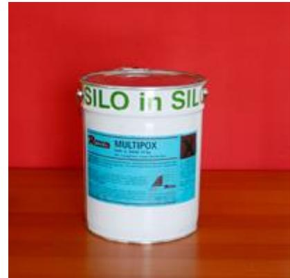
Als farblose Versiegelung oder Kratzspachtelung ab ca. 10 Grad Untergrundtemperatur. Nach 12 - 24 Stunden begehbar, nach 48 Stunden voll belastbar, ab 96 Stunden chemisch stabil gegen Flugkraftstoffe, Heizöle, Diesel, Motoren- u. Getriebeöle, phenolhaltige Gemische sowie Säure und Laugen, beständig auch gegen Tausalz / Ammoniak – Schwefelwasserstoff (Biogasanlagen) s. a. Polyreith / DIBt.
